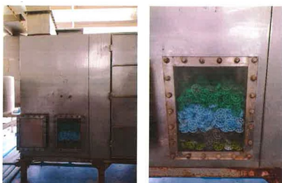
การใส่ลูกมีเดียเพื่อดักจับละอองสี และไอสารเคมี Xylene, Toluene
