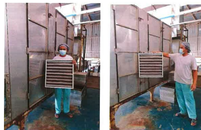
การใส่แผ่นฟิวเตอร์เพื่อดักจับฝุ่น และป้องกันเสียงดัง
