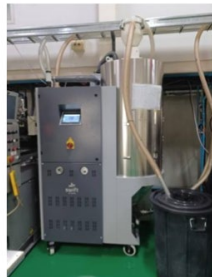
(เครื่องอบเม็ดพลาสติกแบบใหม่ โหลเม็ดพลาสติกให้เครื่องฉีดฯ ได้ 3-4 เครื่อง)
